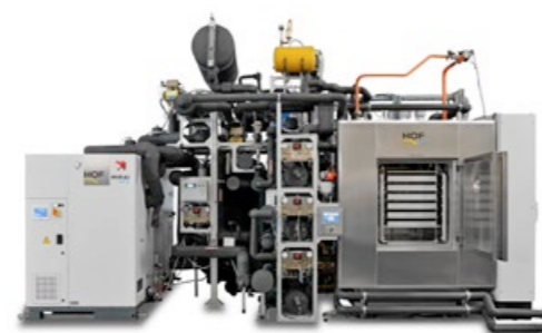
Abb.: Anlage von 1998 nach Umbau auf HOF CryoBlizzard
